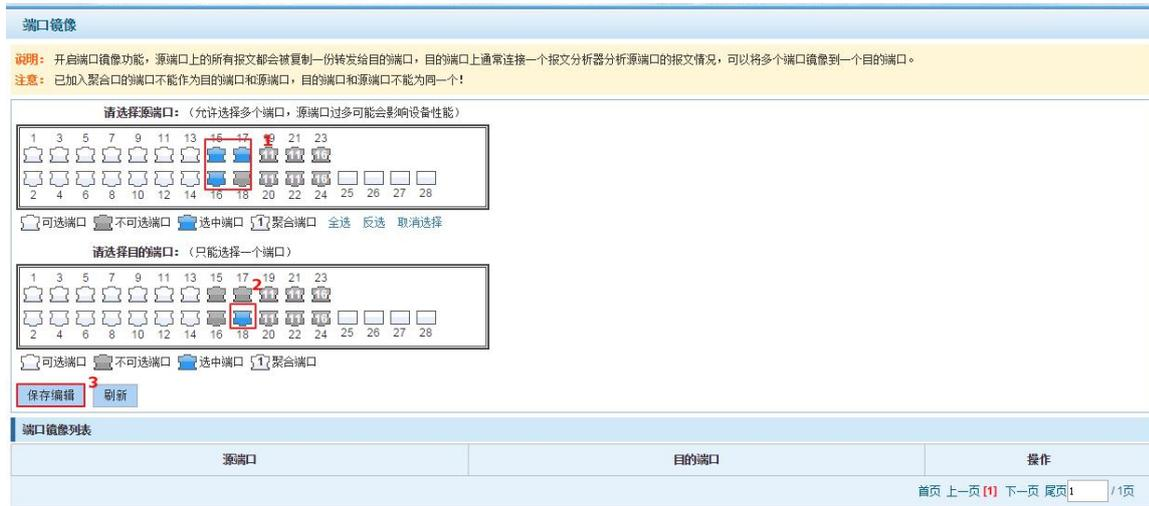
图 5-16 增加端口镜像组
