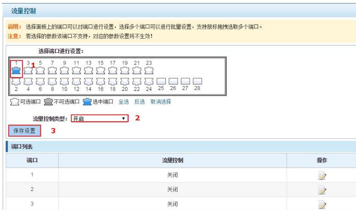
图 5-8 开启端口流量控制功能
