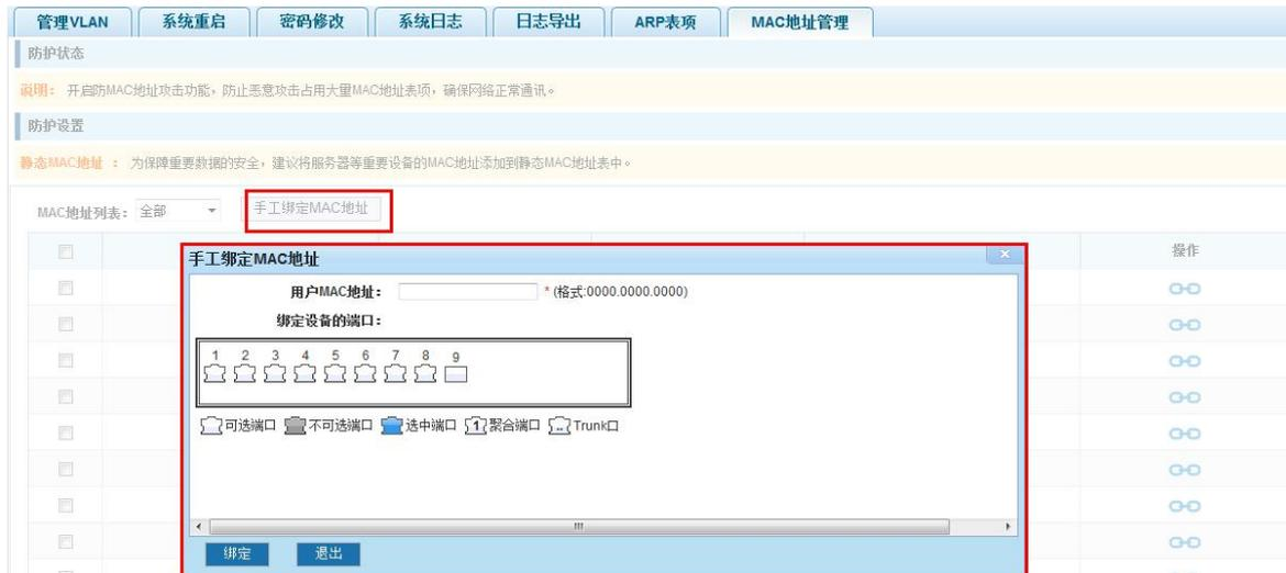
图 8-9 MAC 地址手工绑定静态配置
