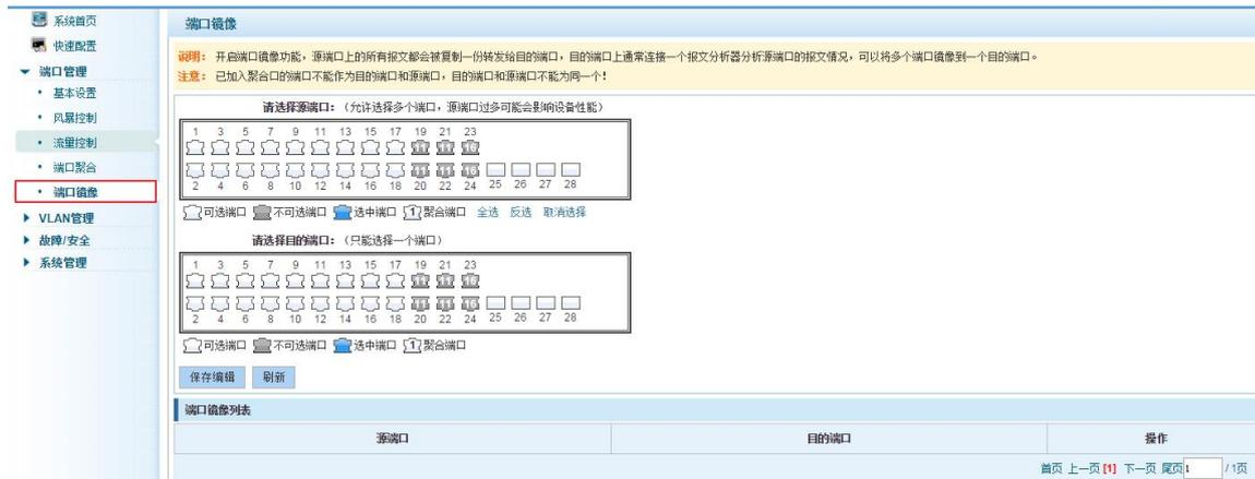
图 5-15 端口镜像的配置信息
